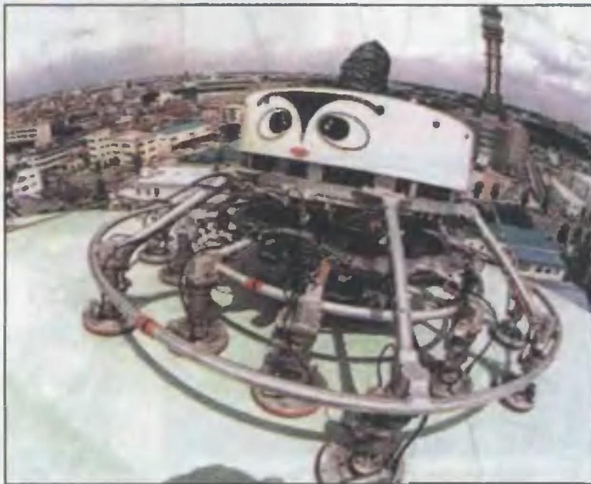
**РОБОТ НА КРЫШЕ** большого бака для сжиженного газа не просто позирует фотографу. Он забрался сюда для того, чтобы тщательно проверить, нет ли в
